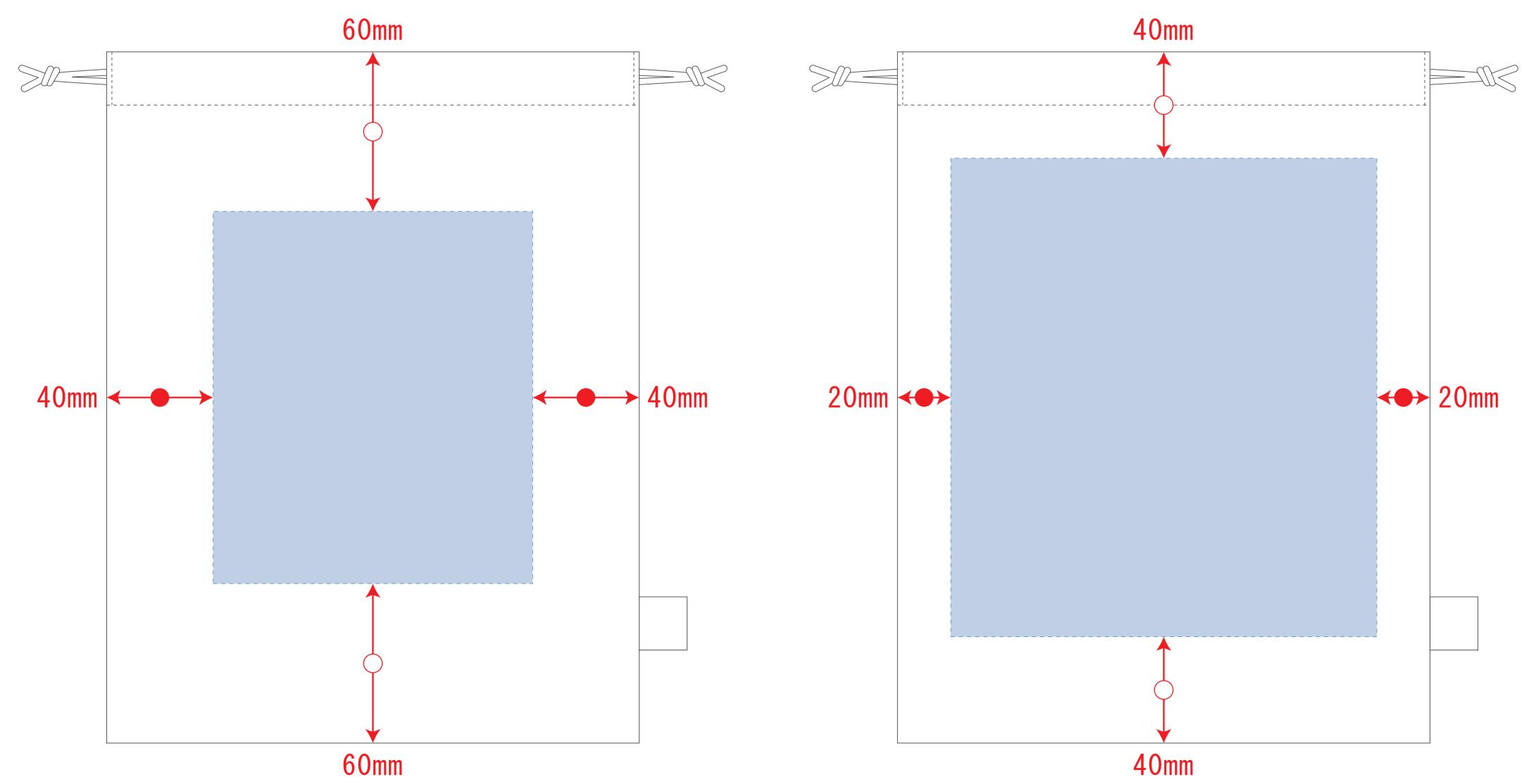
デザインスペース: W120×H140 (mm) ■シルク印刷 最大範囲: W120×H140 (mm) ■熱転写印刷 最大範囲: W120×H140 (mm) デザインスペース: W160×H180 (mm) ■インクジェット印刷 最大範囲: W160×H180 (mm)
